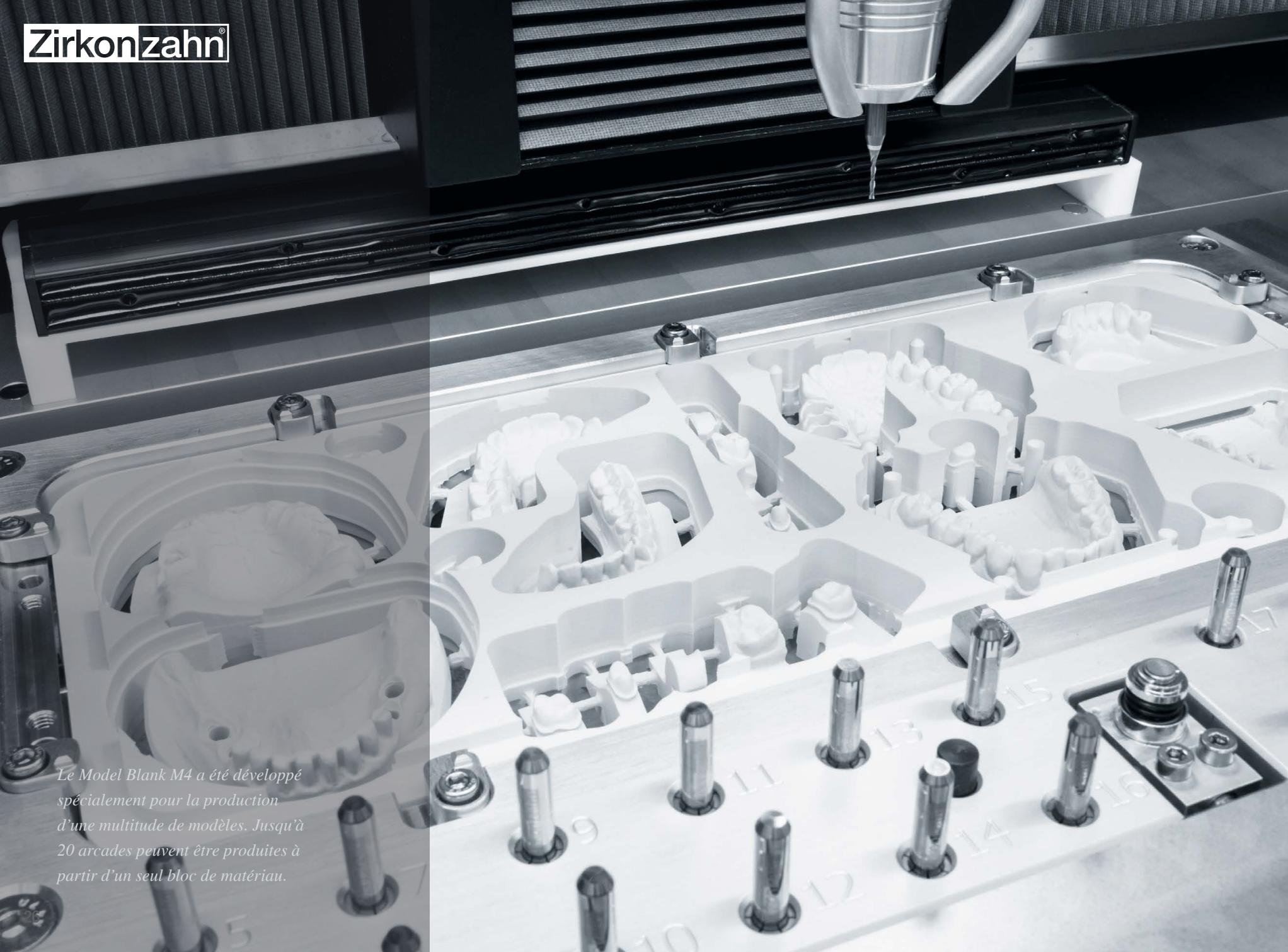
*Le Model Blank M4 a été développé spécialement pour la production d'une multitude de modèles. Jusqu'à 20 arcades peuvent être produites à partir d'un seul bloc de matériau.*
