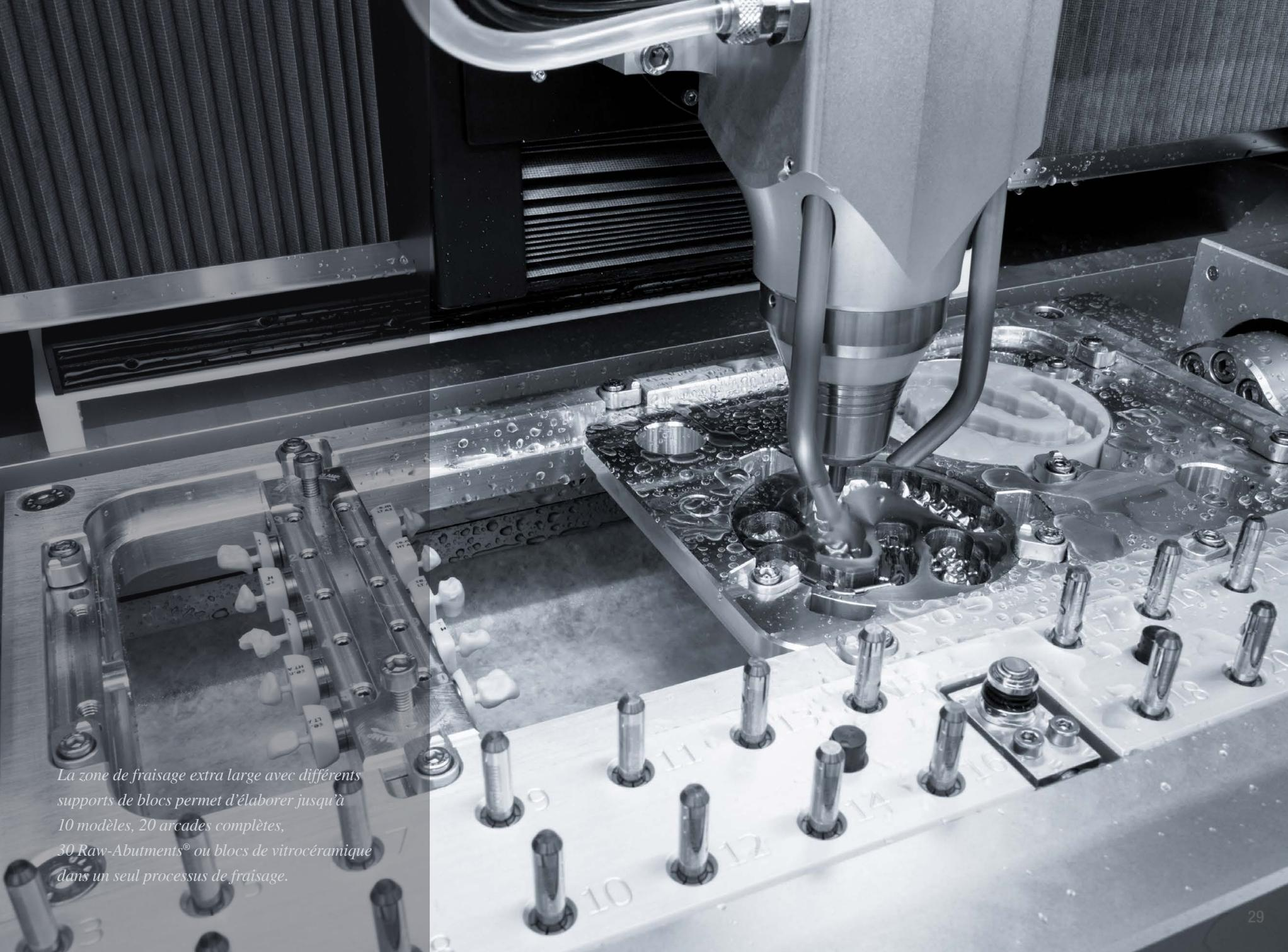
*La zone de fraisage extra large avec différents supports de blocs permet d'élaborer jusqu'à 10 modèles, 20 arcades complètes, 30 Raw-Abutments® ou blocs de vitrocéramique dans un seul processus de fraisage.*
