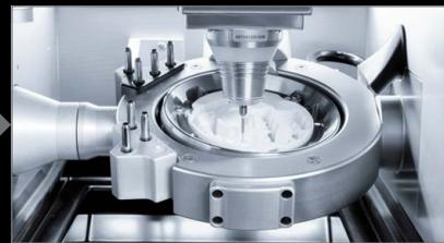
*Fraisage précis de la restauration finale en zircone dans la fraiseuse Zirkonzahn correspondante. Coloration (selon le matériau) et frittage de la structure fraisée.*
